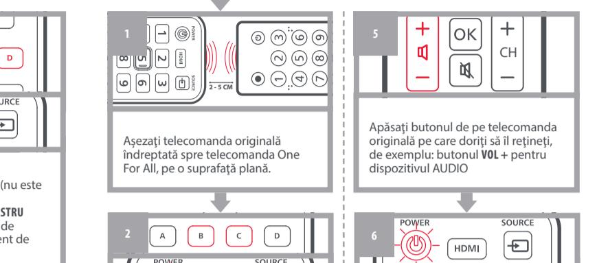
Apăsați butonul de pe telecomandă originală pe care doriti să il rețineti, de exemplu: butonul VOL+ pentru dispozitivul AUDIO
